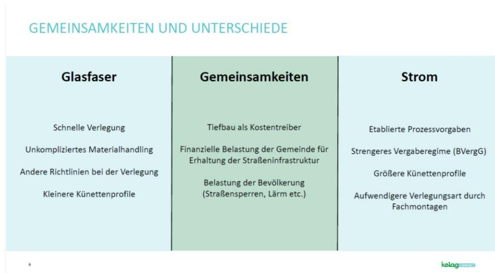
**Abbildung 25: Synergien zwischen Strom- und Kommunikationsnetzen<sup>28</sup>**
